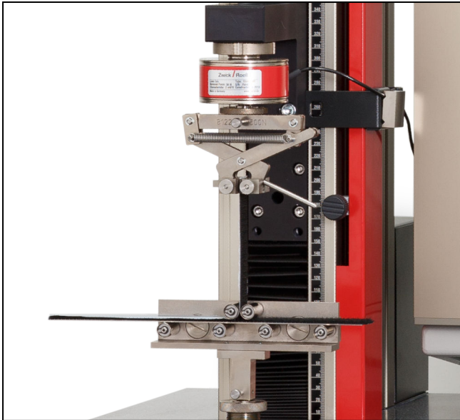
90°-Abziehvorrichtung ( F_{\max} 200 N) mit Zangen-Probenhalter Typ 8122 F_{\max} 500N
