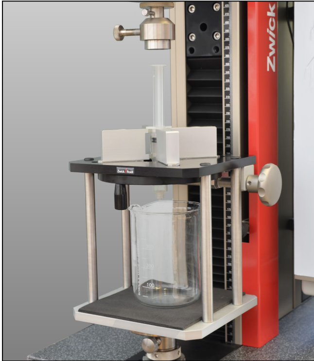
Prüfvorrichtung zur Bestimmung der Losbrech- und Gleitkraft
