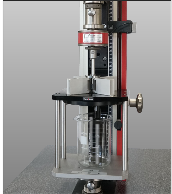
Prüfvorrichtung zur Bestimmung der Losbrech- und Gleitkraft, mit Karpulenaufnahme
