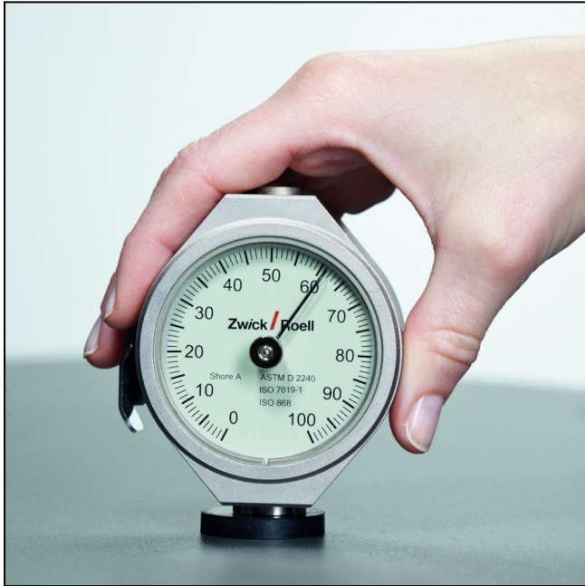
ZwickRoell 3115 Härteprüfgerät nach Shore A mit Schleppzeiger
